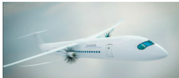
Les innovations du projet AWATAR : voilure haubanée, ailes laminaires et motorisation open-fan .
