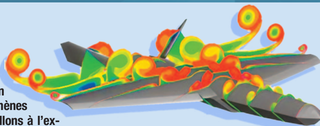
Champ de nombre de Mach autour d'un exemple de configuration étudiée dans le cadre de l'ARF COBRA, au moyen de calculs RANS réalisés avec SoNICS.
