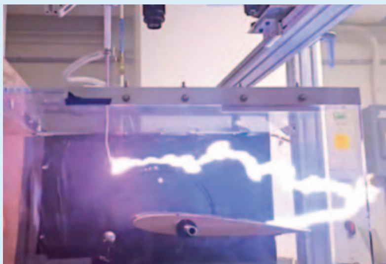
Soufflerie et veine d'essai instrumentées avec le laser et caméra pour la PIV et un profil d'aile NACA12.
