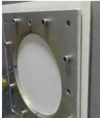
Banc GRIFON. À droite : plaque après foudroiement - Ci-contre : cartographies thermiques à t = 10 ms et t = 200 ms et estimation de l'aire d'endommagement.
