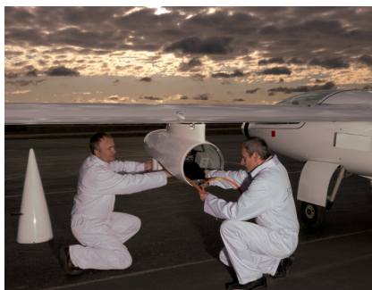
Montage d'un pod optronique (visible et infrarouge) sur le laboratoire volant Busard (moto-planeur)
