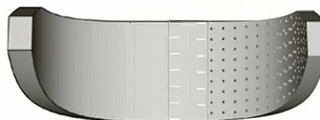
Schéma d'un appui-tête sans (gauche) et avec absorbant (droite)
