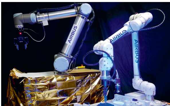
Les bras robotiques spatiaux VISPA (Versatile In-Space and Planetary Arm) d'Airbus Defence and Space pour la réalisation d'opérations en orbite © Airbus Defence and Space / tiré de la vidéo de démonstration https://www.youtube.com/watch?v=FrABdrcqL5g
