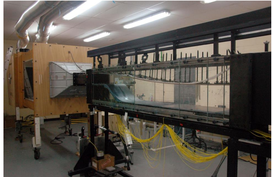
Montage marche descendante avec gradient de pression réglable
